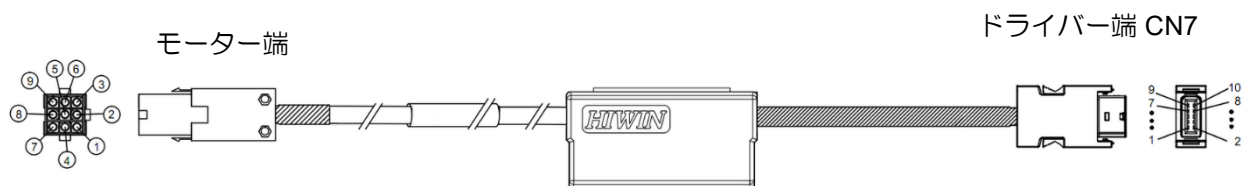
図16.1.2.2 エンコーダー延長ケーブル（HVE23AAB□□MB、シリアルアブソリュートタイプ、電池ボックス付き）
