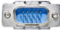
図 5.2.1.4 D-sub VGA 15 Pin
