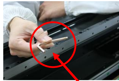
図 4.1.1.3.2 非磁性工具を使用してステーターを取り付けます
