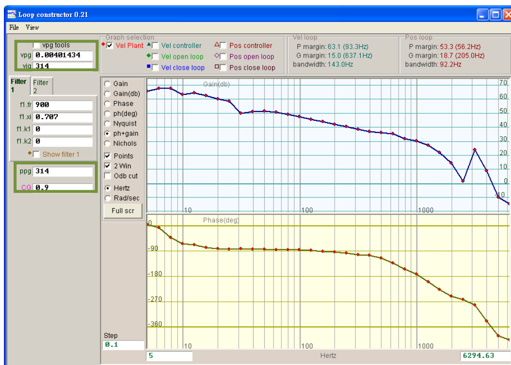
図6.7.4.1 ループ コンストラクターでのゲイン調整
