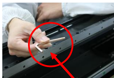
図4.1.1.3.2 非磁性工具を使用してステーターを取り付ける
