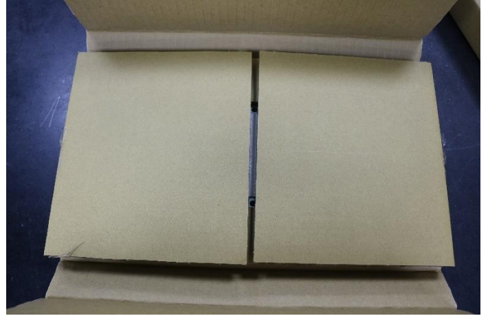
(4) 内箱を取り出し、ステーターを取り出します。 (同時に複数のステーターを開梱しないでください)
