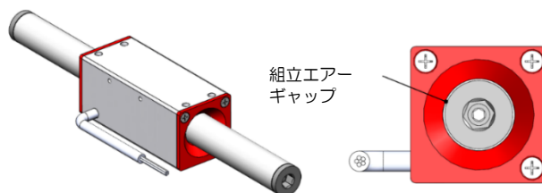
図2.1.1.5.3 フォーサーとステーターの構造
