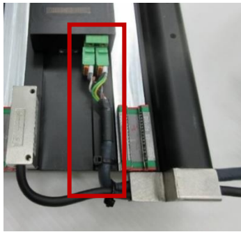
図 3.3.1.4.16 ケーブルタイとケーブルトレイでモーターケーブルを固定する
