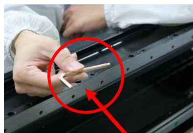
図4.1.1.3.2 非磁性工具を使用してステーターを取り付ける
