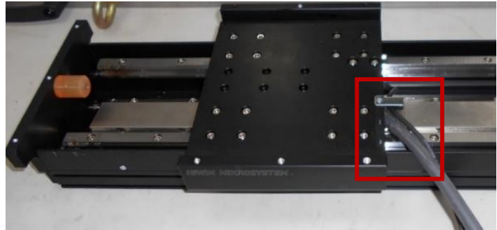
図 3.3.1.4.18 延長ケーブルが固定されていない
