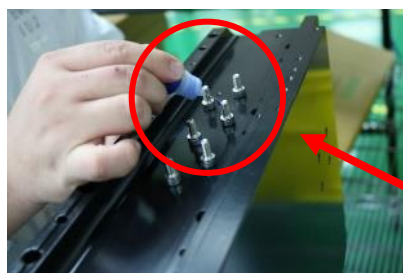
図4.1.1.3.1 ネジにロックタイトを塗布
