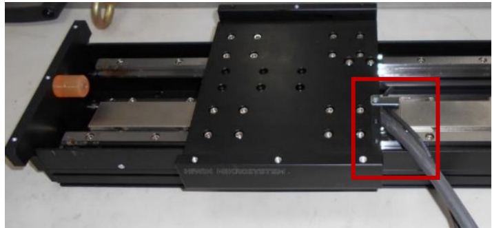
図 3.3.1.4.7 延長ケーブルが固定されていない
