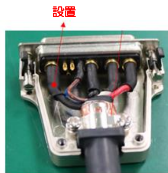
図 3.3.1.3.1 コアレスリニアモーターの接地保護
