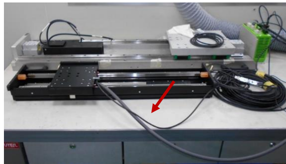
図 3.3.1.4.8 延長ケーブルがケーブルチェーンに入っていない
