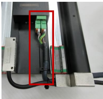
図 3.3.1.4.5 ケーブルタイとケーブルトレイでモーターケーブルを固定します
