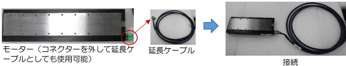
図 3.3.1.4.7 モーターと延長ケーブルの接続
