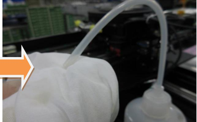
(c) ステーターは吸着性があるため、以下の手順に従ってステーターを拭き、ステーターの端の汚れを取り除いてください。
