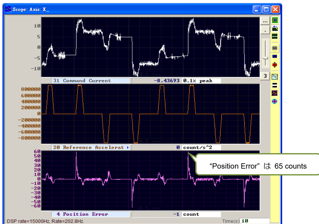
図 6.6.2.4 加速度フィードフォワードを付加した結果
